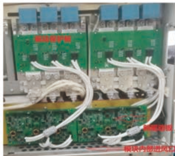
图9 改造后的驱动板安装位置图
