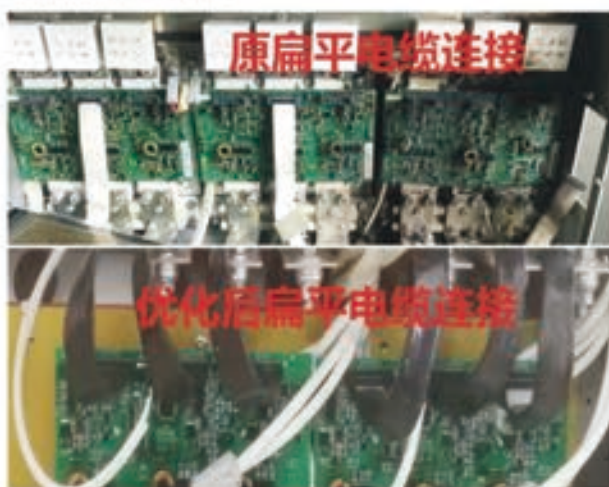
图11 改造前、后控制排线连接方式对比图
