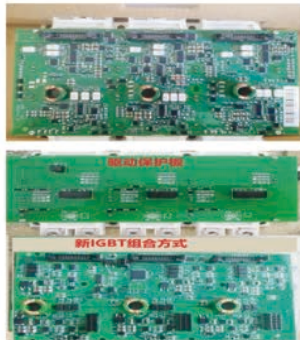
图8 改造前和改造后的IGBT对比
