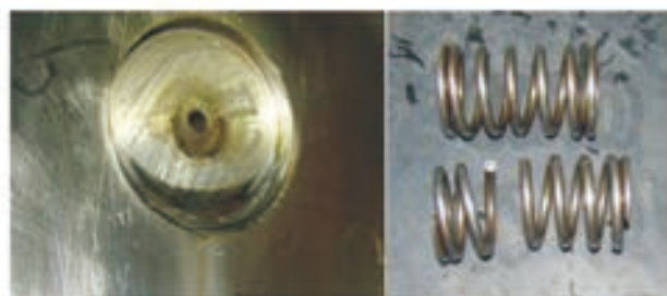
图7:可倾瓦柱销磨损和弹簧断裂照片
